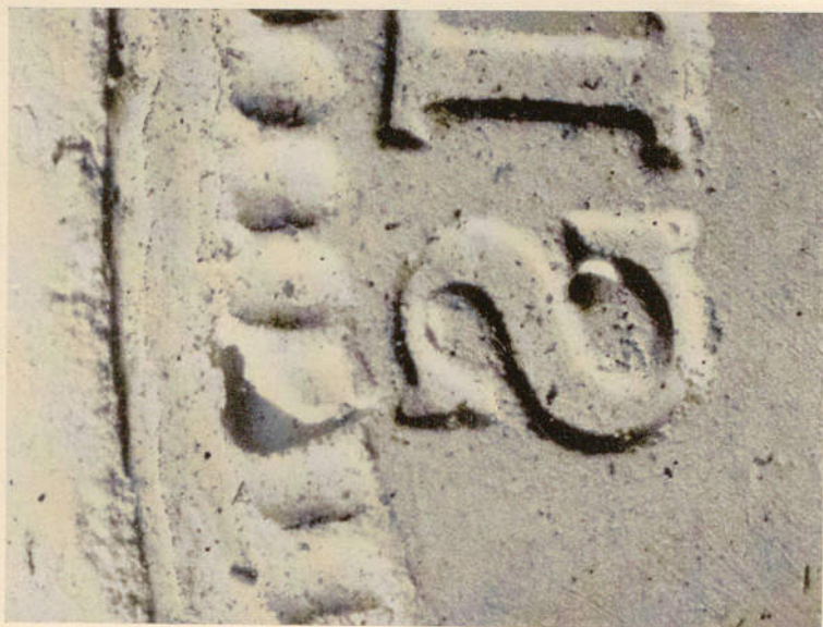
Fig. 43. — Fausse monnaie : Même défaut caractéristique (petit creux dû à une bulle d'air dans le S) sur le moule employé par le faux monnayeur.
