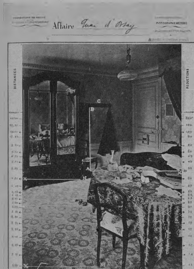
FIG. 18. — COMMENT ON CALCULE LES DISTANCES ET LES HAUTEURS SUR UNE PHOTOGRAPHIE METRIQUE. (Service de l'identité judiciaire de Paris.) L'échelle des distances, à gauche, sert à calculer les distances entre les objets placés sur le sol; l'échelle des réductions, à droite, sert à calculer la hauteur des objets au-dessus du sol.
